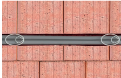
Kabelbefestigung in Wandschlitzten > 30 mm
