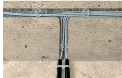
Kabelbefestigung in Wandschlitzten < 55 mm
